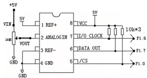
图5 TLC549AD 转换电路原理图
