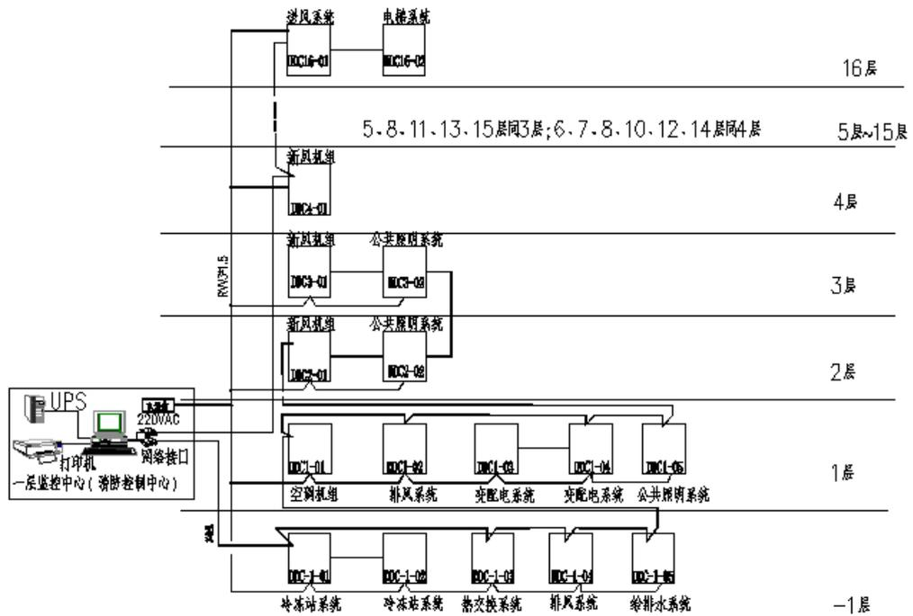
图 1 BA 系统总控制网络图
