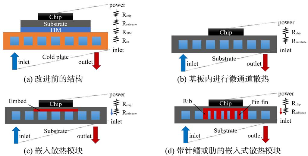
图 1.2 三种强化传热途径示意图
